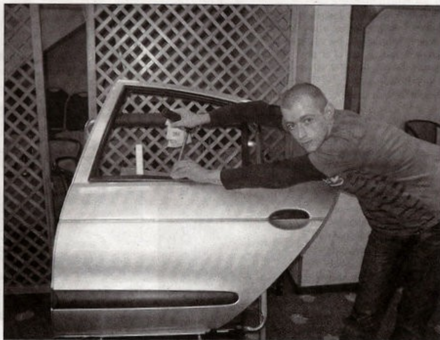
Sous la lumière, le technicien peut "lire sa bosse" tout en massant. 100 à 300 pressions permettent de la faire disparaître entièrement.
